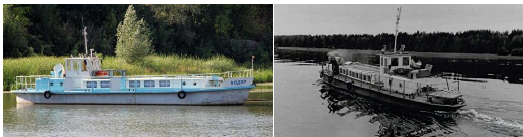
Рис. 8. Переделка серийных «Такелажниц» в пассажирский вариант слева катер «Кодор» ( http://fleetphoto.ru/photo/102679 ) и справа – катер «Школьник» ( http://fleetphoto.ru/photo/273554 )
